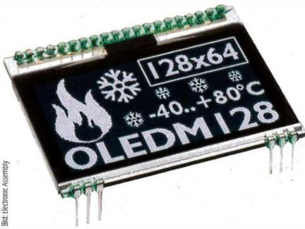
Flaches monochromes LCD-Grafikmodul mit negativer Darstellung.
