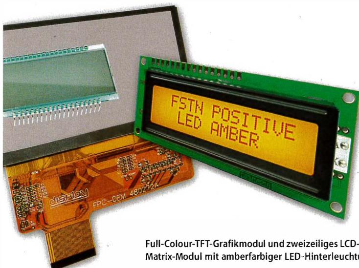
Full-Colour-TFT-Grafikmodul und zweizeiliges LCD-Dot-Matrix-Modul mit amberfarbiger LED-Hinterleuchtung.
