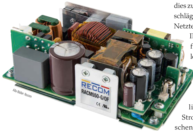
Bild 2: Das kontaktgekühlte AC/DC-Netzteil RACM-550 ist nach diversen Sicherheitsstandards zertifiziert.
