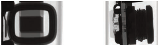
7.18: Röntgenvergleich zwischen einer geschirmten Induktivität, verwendet in RECOMs Sperrwandler R-78 (Abbildung links), und einer ungeschirmten Induktivität, verwendet in dem kopierten Produkt eines Mitbewerbers (Abbildung rechts)
